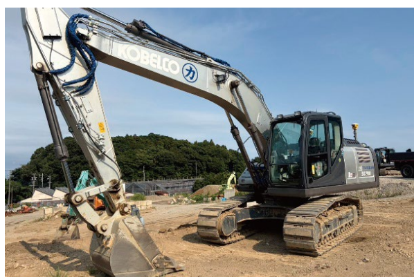
▲ICT等最新技術を搭載した油圧ショベル
